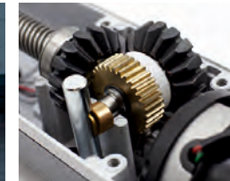
Solidna metalowa przekładnia (APO424PRO)
