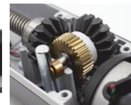
Solidna metalowa przekładnia (APO424)
