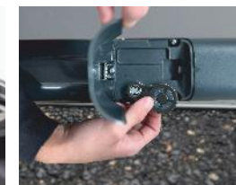
Możliwość wysprzęglenia siłownika za pomocą specjalnego uchwytu w pilocie
