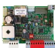
Centrala sterująca z wbudowanym wyświetlaczem
