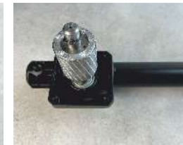
Solidna metalowa przekładnia na łożyskach kulkowych
