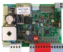
Centrala sterująca z wbudowanym wyświetlaczem
